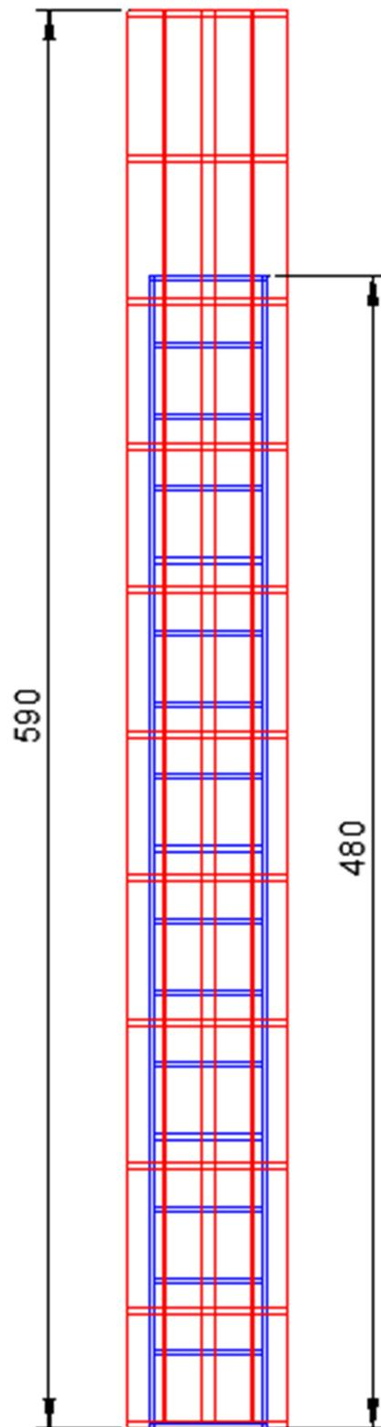
Figura 1 - Dimensões da escada e do guarda-corpo
