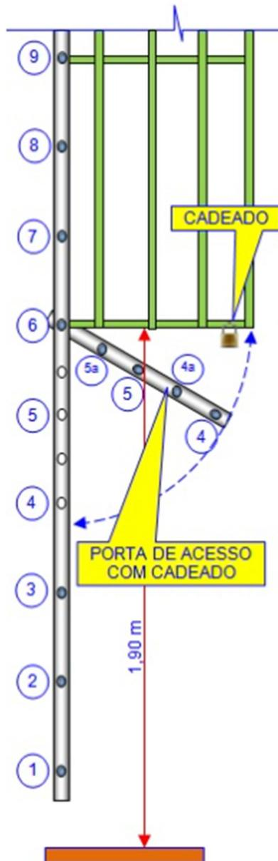
Figura 3 - Parte inferior deverá ser dotada de portinhola para impedir a entrada de pessoas não autorizadas conforme imagem a seguir.
